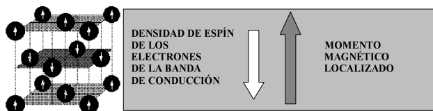
FIGURA 6. Representación del efecto Kondo, interpretado como el AAFM entre los espines de los electrones de la banda de conducción y el momento magnético localizado del metal.
