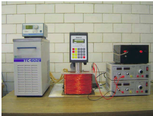
FIGURA 3. Sistema de magneto-reometría: al centro, el reómetro de cono-plato inmerso parcialmente en el solenoide; a la derecha, las fuentes de poder que alimentan el solenoide; y a la izquierda, el baño refrigerante.
