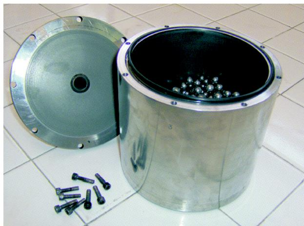
FIGURA 1. Molino de bolas que se usó para trituar los óxidos de hierro. Se observan los balines de diferentes diámetros.
