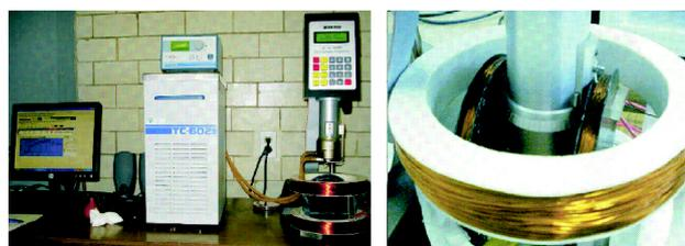
FIGURA 4. Equipo experimental para el estudio de la viscosidad efectiva. Las bobinas de Helmholtz son las mismas que las usadas para el estudio de microscopía pero están colocadas de tal forma que el campo estático es vertical y el senoidal es horizontal. En (a) el sistema cono-plato está fuera de las bobinas, para poder colocar la muestra, y en (b) está dentro de ellas.
