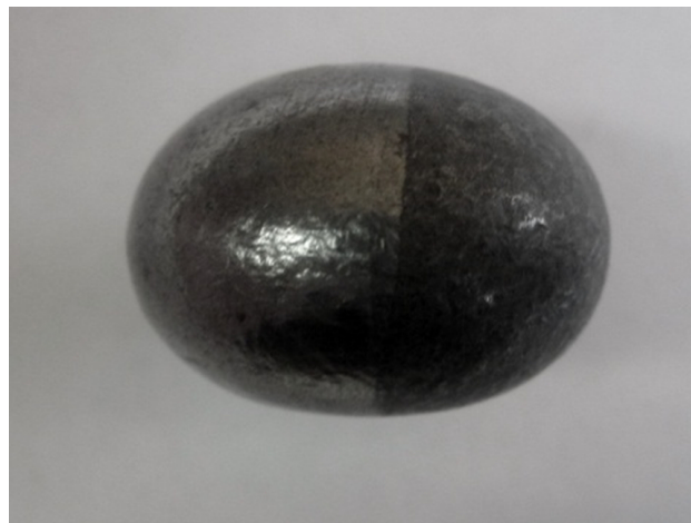
FIGURA 4. Rotor de acero, originalmente esférico (diámetro = 2.54 cm) deformado por centrifugación.
