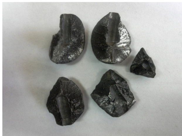
FIGURA 5. Fragmentos de un rotor después de explotar.
