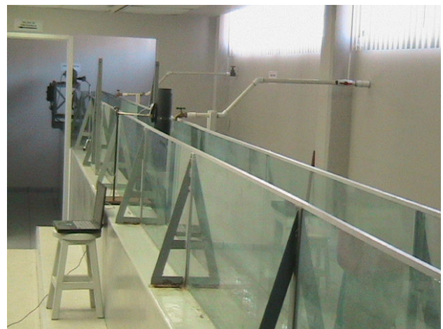
FIGURA 1. Vista parcial del canal de olas de la Facultad de Ciencias Marinas, UABC. En el fondo se puede apreciar el generador de olas.
