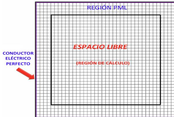
FIGURA 1. Región PML en una malla FDTD bidimensional.
