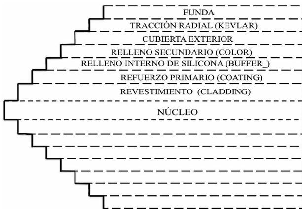
FIGURA 4. Representación de los límites de las celdas para cada revestimiento de la fibra óptica.
