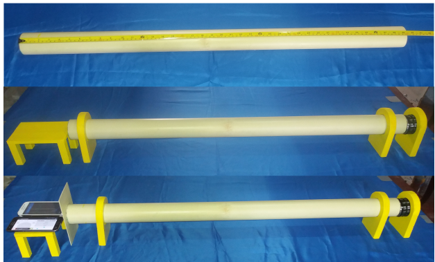
FIGURA 14. Tubo abierto y cerrado con el mini altavoz bluetooth en el extremo.
