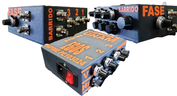
FIGURA 8. EGOS Estación Generadora Operativa de Señales.
