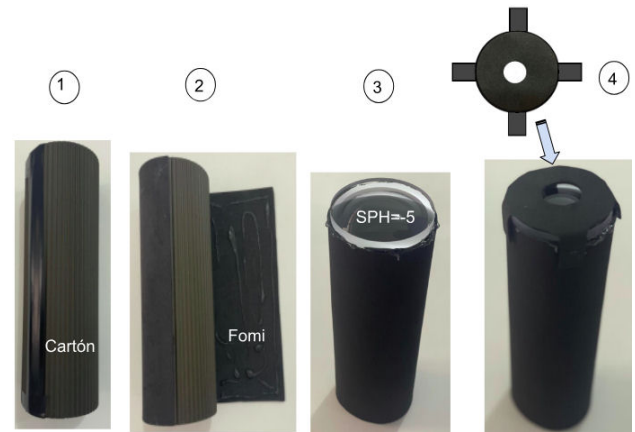
FIGURA 5. Preparación del tubo 2 para montar la lente SPH = -5 , o lente ocular del telescopio.
