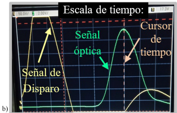
FIGURA 7. a) Diagrama del arreglo experimental con un recorrido más largo. b) Señales observadas en el osciloscopio.
