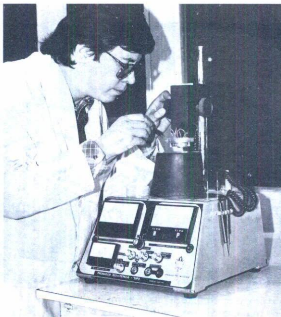
Fig. 10. Probador "Tipo" de 4 puntas UAP 784. Esta máquina sirve para determinar la resistencia de cuadro y si un semiconductor es de tipo "P" o "N".
