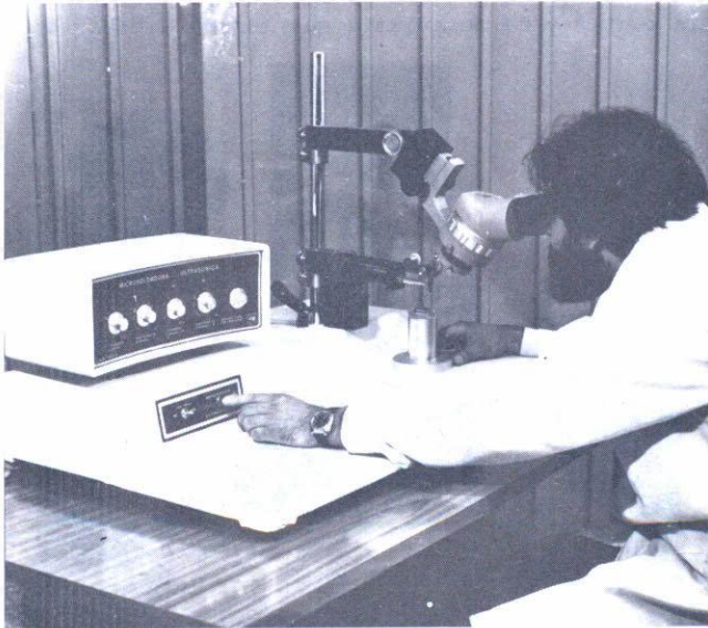
Fig. 8. Microsoldadora Ultrafónica UAP 7907-A. Este aparato es un segundo prototipo para soldar los microcircuitos a las patas de la escolopendra; puede soldar alambre de un diámetro de 20 micras.
