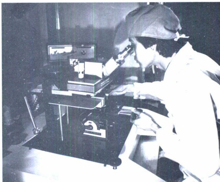
Fig. 22. Aleación de la oblea de silicio con su respectivo patrón o mascarilla.
