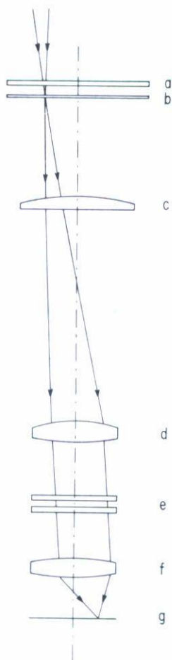
Fig. 2. Esquema de un reductor focal: a-filtro de interferencia, b-foco del reflector donde se encuentra una retícula cuya sombra produce los ejes cartesianos, observados en las fotografías, c-lente de campo, d-colimador, e-etalón Fabry-Pérot, f-objetivo de cámara, g-detector.
