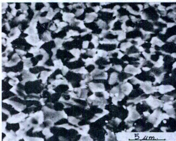
Fig. 6. Granos finos obtenidos al originarse una transformación espino. durante el temple en la misma aleación de la Fig. 5 (M.E.B.).
