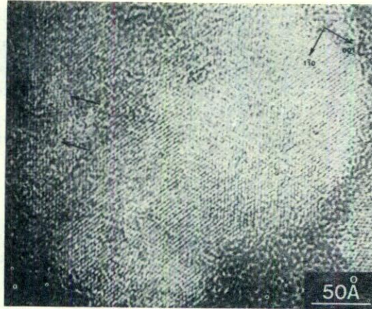
FIGURA 4. Imagen de alta resolución de una muestra 75 \text{ \AA} \text{ Au}/15 \text{ \AA} \text{ Cu} correspondiente a la epitaxia (110) \text{ Cu}_2\text{O}/(111) \text{ Cu} . Nótese las áreas que contienen celdas en forma de diamante (centro) y las regiones marcadas con R que muestran una estructura rectangular no esperada de la cristalografía del volumen.
