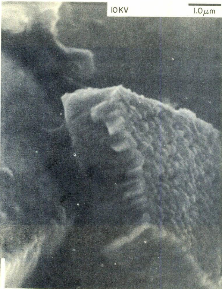
FIGURA 3. Vista típica al microscopio electrónico de la sección transversal de una película policristalina de CdTe. Se aprecia claramente el crecimiento columnar de los gránulos de CdTe en esta fotografía.
