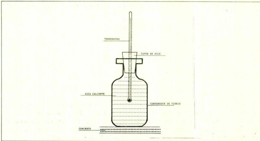
FIGURA 1. Arreglo experimental para determinar la razón de enfriamiento.
