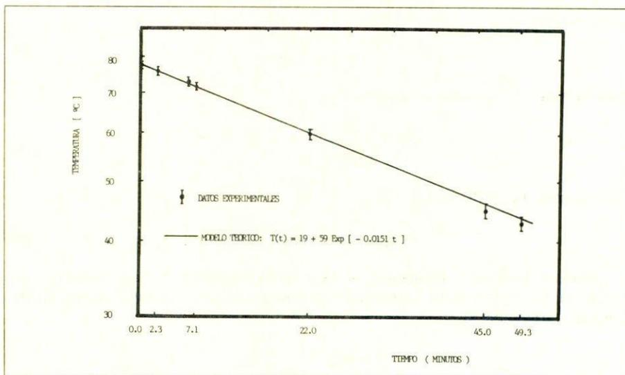
FIGURA 2. Comparación entre las mediciones experimentales y el modelo teórico.
