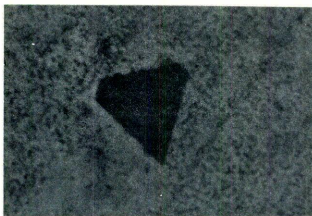
FIGURA 5. Micrografía electrónica de barrido de un precipitado rico en Si. Su composición química en peso es aproximadamente Si-30%Zn-5%Cu-4%Al (EDS-MEB/ESIQIE) X 4800.
