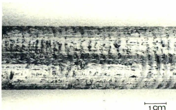
FIGURA 1. Apariencia superficial de una barra de Zinalco obtenida por colada semicontinua.
