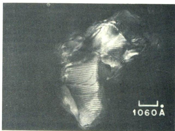
FIGURA 2. Campo oscuro de la misma zona; se aprecian franjas de Moiré.
