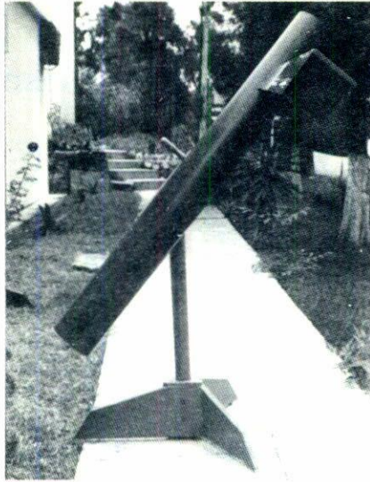
FIGURA 9. Fotografía de un telescopio newtoniano ( f/8 ) con la estructura de la pantalla de observación montada.
