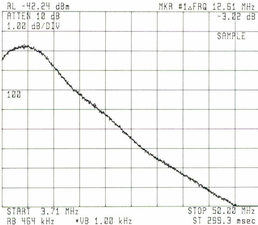
FIGURA 5. Densidad espectral de la fotocorriente en escala logarítmica hasta 50 MHz.
