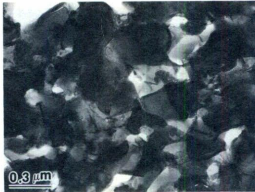
FIGURA 6. Microestructura a 240°C para 150% de deformación.
