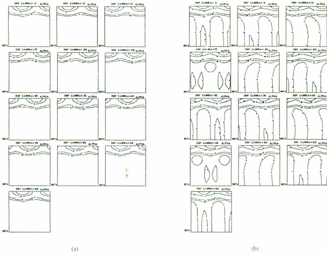
FIGURA 8. (a) FDOC completa simulada con una componente (001)[100]. (b) FDOC simulada con la misma componente pero donde solo aparecen los términos pares del desarrollo en serie.
