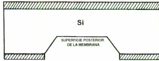
FIGURA 1. Membrana de silicio usada para el experimento de inyección de auto-intersticiales por la superficie posterior y monitoreo del crecimiento de fallas de apilamiento en la superficie frontal.
