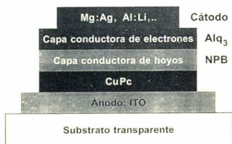
FIGURA 2. Estructura de un diodo electroluminescente de alta estabilidad. Los espesores de las capas son: ITO (30 nm), CuPc (15 nm), NPB (60 nm), Alq 3 (750 nm), y el cátodo (200 nm).
