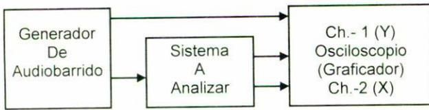
FIGURA 2. Conexión básica para análisis de sistemas.
