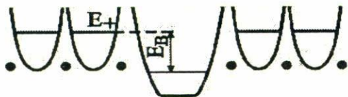
FIGURA 1. Distribución de la energía potencial del positrón dentro de una red cristalina. E_+ representa la energía potencial del positrón, la cuál tiene un valor más pequeño en las zonas donde hay presencia de vacancias y E_B es la energía de enlace del positrón a dichas zonas.
