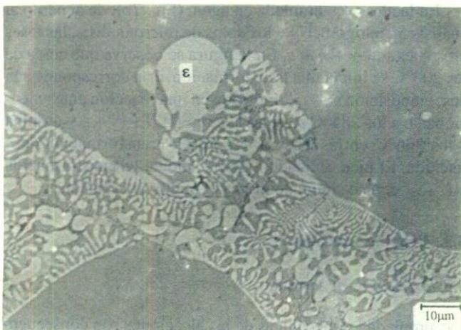
FIGURA 4. Zinalco V, templado en agua; matriz de grano fino de fases  $\alpha$  y  $\eta$ , con fase  $\epsilon$  en forma de granos alargados conteniendo perlita de  $\alpha$  y  $\eta$ .
