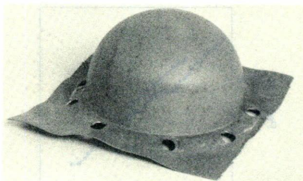
FIGURA 7. Cascarón metálico de la aleación superplástica Cd-Zn-Cu, producido a partir de una placa plana.
