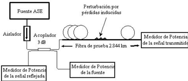
FIGURA 1. Diagrama esquemático del sensor de fibra óptica.
