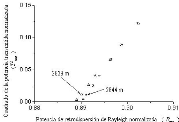
FIGURA 7. Relación entre las potencias transmitida y de retrodispersión de Rayleigh normalizadas para pérdidas inducidas por curvatura en 2844 m (O) y en 2839 m ( $\Delta$ ).
