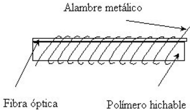
FIGURA 3. Construcción del elemento sensible de fibra óptica.
