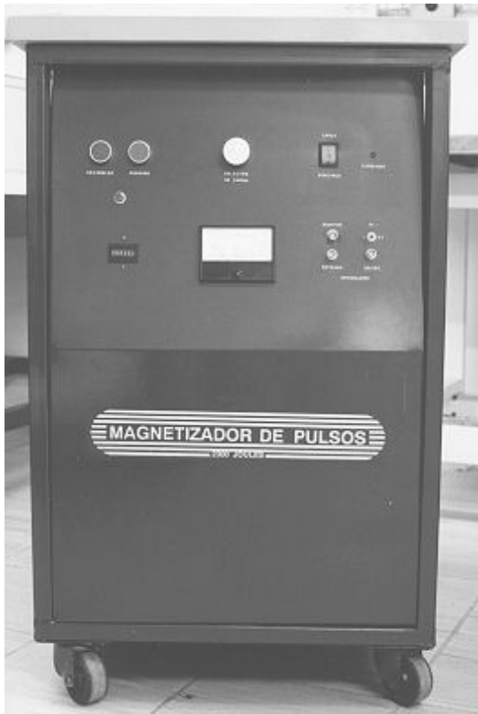
FIGURA 7. Vista frontal del magnetizador de pulsos.
