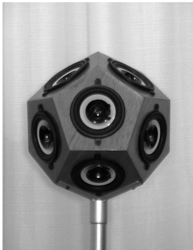
FIGURA 2. Fuente Sonora Omni-direccional (FSO) completa con su soporte para tripié.
