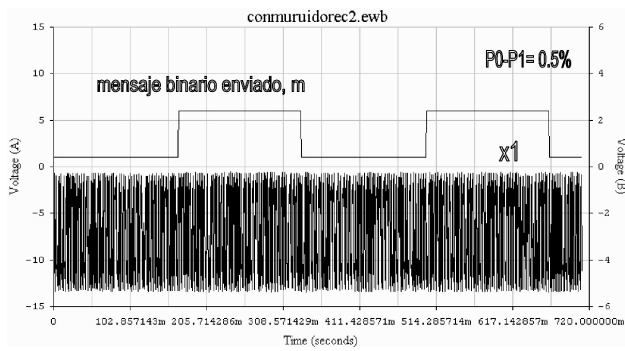
FIGURA 6. Muestra el mensaje binario m ( f_m = 3\text{Hz} ) y la forma de onda de la señal caótica sincronizadora x_1 ; observe el cambio que sufre ésta, al conmutar el mensaje de 0 a 1 para un \Delta P de 0.5 %, es casi imperceptible.
