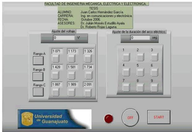
FIGURA 8. Menú de programación de la fuente de alto voltaje con la que se puede ajustar el tiempo de duración del arco eléctrico y el nivel del voltaje aplicado.
