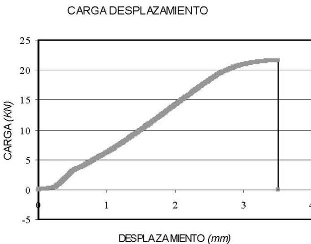
FIGURA 4. Resultados de los ensayos a tensión para la fila  $y = 0$ .
