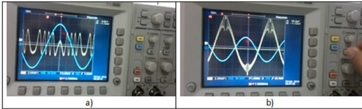
FIGURA 12. Interferograma (línea amarilla) a) fuera de resonancia y b) en resonancia.
