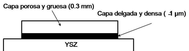
FIGURA 5. Representación de dos capas para el electrodo catódico.
