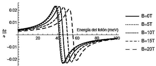
FIGURA 6. Cambio de índice de refracción total como una función de la energía del fotón incidente  $\hbar\omega$  para cinco valores diferentes del campo magnético externo ( $B = 0T$ ,  $B = 5T$ ,  $B = 10T$ ,  $B = 15T$ ,  $B = 20T$ ), con  $L = 10$  nm y  $R = 8$  nm.
