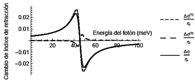
FIGURA 5. Cambio de índice de refracción lineal, no lineal y total en función de la energía del fotón incidente  $\hbar\omega$  con intensidad óptica de  $I = 0.2$  MW/cm<sup>2</sup>, un campo magnético externo de  $B = 10T$ ,  $L = 10$  nm y  $R = 8$  nm.
