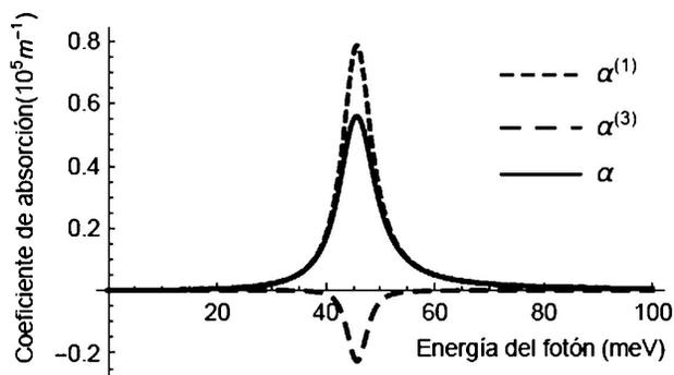
FIGURA 1. Coeficientes de absorción óptica lineal, no lineal y total en función de la energía del fotón incidente  $\hbar\omega$  con intensidad óptica de  $I = 0.2 \text{ MW/cm}^2$ , un campo magnético externo de  $B = 10T$ ,  $L = 10 \text{ nm}$  y  $R = 8 \text{ nm}$ .
