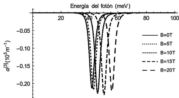
FIGURA 3. Coeficiente de absorción óptica no lineal como una función de la energía del fotón incidente  $\hbar\omega$  para cinco valores diferentes del campo magnético externo ( $B = 0T$ ,  $B = 5T$ ,  $B = 10T$ ,  $B = 15T$ ,  $B = 20T$ ), con  $L = 10 \text{ nm}$  y  $R = 8 \text{ nm}$ .
