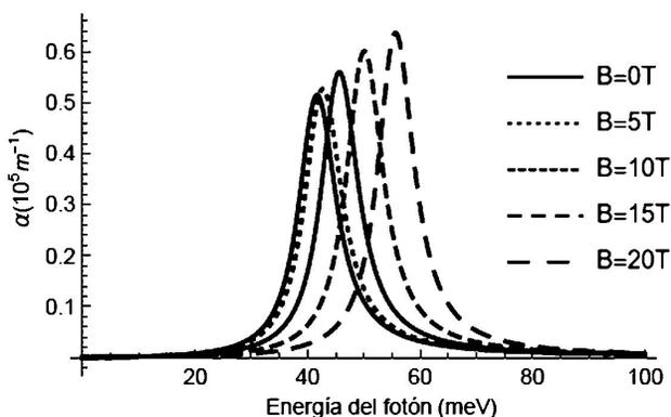
FIGURA 2. Coeficiente de absorción óptica total como una función de la energía del fotón incidente  $\hbar\omega$  para cinco valores diferentes del campo magnético externo ( $B = 0T$ ,  $B = 5T$ ,  $B = 10T$ ,  $B = 15T$ ,  $B = 20T$ ), con  $L = 10 \text{ nm}$  y  $R = 8 \text{ nm}$ .
