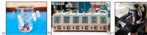
FIGURE 2. a) Vaso de Pyrex (de 150 ml de capacidad) que contiene 5 detectores LR-115 y 110 ml de NaOH; dentro de un vaso de Pyrex (de 500 ml de capacidad) con 200 ml de agua. b) Como se muestra en la Fig. 2a), se preparan 6 arreglos, que son luego colocados en el baño térmico. c) Lectura de los detectores LR-115 con el microscopio óptico marca LEICA, modelo DM LM.
