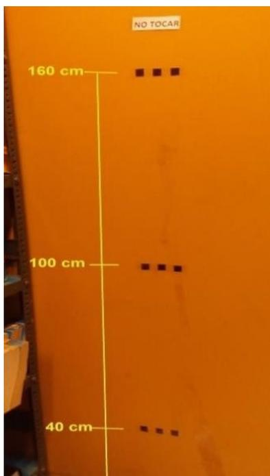
FIGURE 1. Arreglo de detectores LR-115 colocados en la pared, a alturas desde el piso de 40, 100 y 160 cm.
