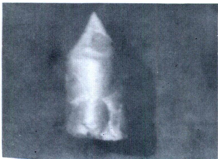
Fig. 4.- Policristal de bismuto atacado químicamente.
